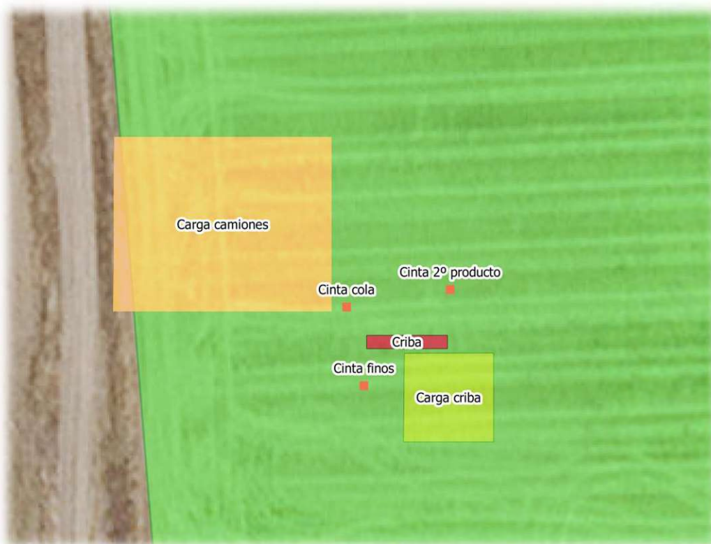
Figura 9.- Áreas de emisión introducidas en el modelo para la maquinaria de S. San Blas A
